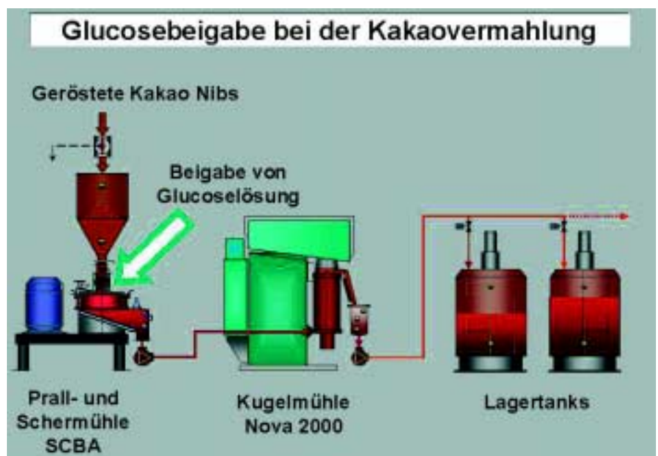
Abbildung 2: Verfahrensschema zur Glucoseinjektion während der Kakaomasseherstellung
