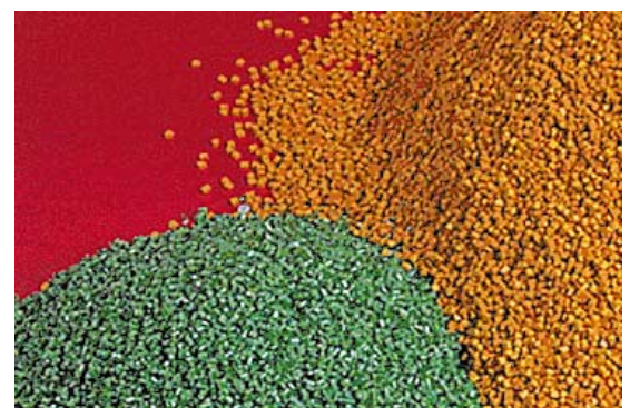
Abbildung 3: Kunststoffgranulat, gefärbt mit Chlorophyll (grün) und Riboflavin (gelb)
