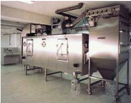
Bild 2B: Pilot-Sprühtrocknungsanlage Box-Dryer, Werksfoto der Fa. Sanovo
