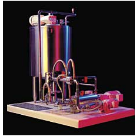
Foto 1: Kristallisationseinheit SeedMaster cryst zur Herstellung der Kakaobutterkristallsuspension.
