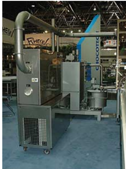
Interpack life: Das Luftentfeuchtungssystem ML-Plus (links im Vordergrund) neben einer Frozen Shell-Anlage – wie im praktischen Alltag.
