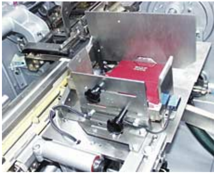
Längsfaltung und Siegelung: die erste Stufe.
