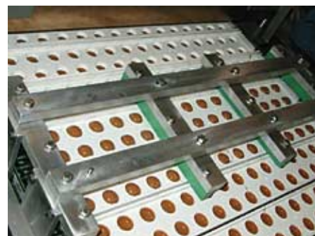
Die Schalenformvorrichtung: Der obere Teil zeigt die Form nach dem Füllen, der mittleren Teil den Vorgang beim Ausbilden der Schalen und der untere Teil zeigt, wie die Schale ausgebildet wird.
